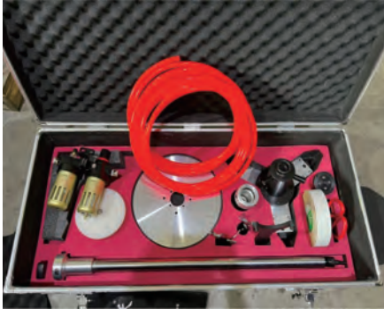
客戶：中龍鋼鐵 工序：高壓焊口閘閥線上研磨
